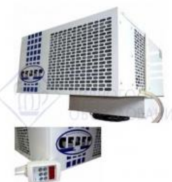
BSB 218 S Моноблок низкотемпературный потолочный (6,0-15,0 м 3 ) 120x115x100 (-5... +10°C) 220 В*. Север
